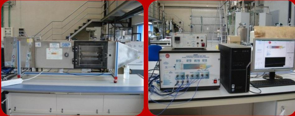
La planta piloto de deshidratación por convección permite deshidratar muestras con un control exhaustivo de la temperatura y la velocidad del aire de secado, de forma similar al procesamiento convencional realizado en la industria.
