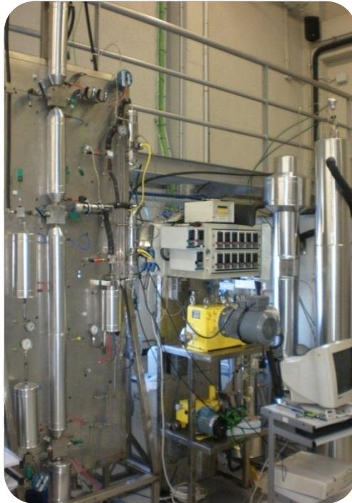
**Planta de extracción con CO<sub>2</sub> supercrítico para muestras sólidas y líquidas (Escala semi-piloto)**
