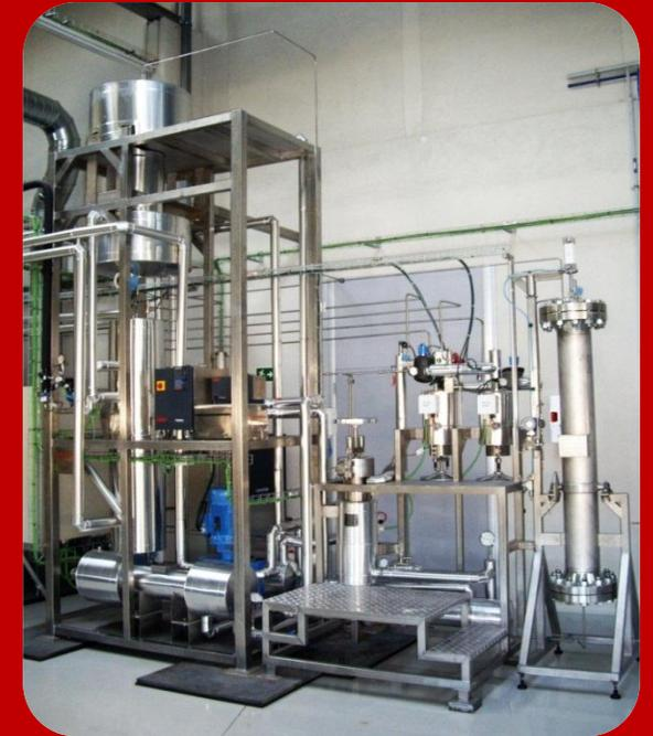
La planta tiene un peso de 3200 kg, y unas dimensiones de 3,15 x 1,40 x 4,36 m. Cuenta con un depósito de CO<sub>2</sub> líquido de 80 L de capacidad y una bomba de CO<sub>2</sub> líquido capaz de trabajar con caudales de hasta 76 L/h. La capacidad de la celda de extracción es de 6L y la de los dos separadores de 1,7 L cada uno. La planta cuenta con un sistema de recirculación de CO<sub>2</sub> constituido por un depósito, un condensador y un precalentador de CO<sub>2</sub>.
