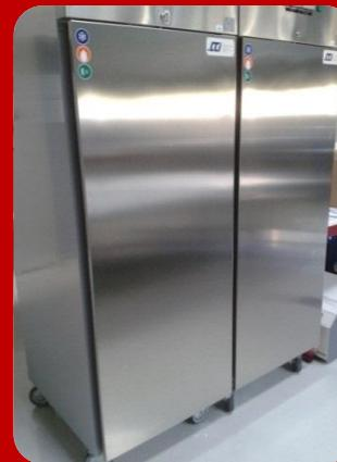
Las cámaras climáticas CCI STD/FARM destinadas a conocer la estabilidad de gran variedad de productos, en diversas condiciones climáticas de frío, calor y humedad. Oscilan en un rango de temperaturas entre 0 y 50 °C
