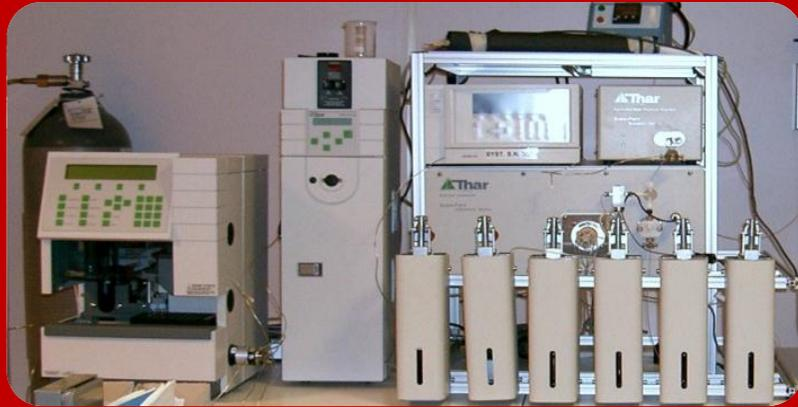
Equipo de cromatografía supercrítica con CO<sub>2</sub> como fase móvil, de escala analítica y semi-preparativa. Flujos de 1 a 10 g/min de CO<sub>2</sub>, presiones de hasta 30 MPa y temperaturas entre 25 y 60°C. Cuenta
