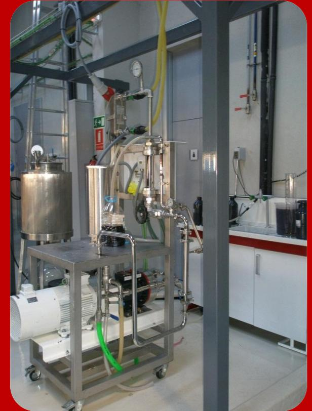
Planta muy versátil que puede albergar membranas de micro-, ultra-, nano- e hiper- (ósmosis inversa) filtración, de distinta configuración (planas enrolladas en espiral o empaquetadas en casetes, fibra hueca, capilares o multicanales) y materiales (polímeros o minerales).
